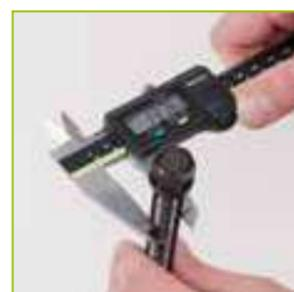
a Misurare il diametro della vite.
