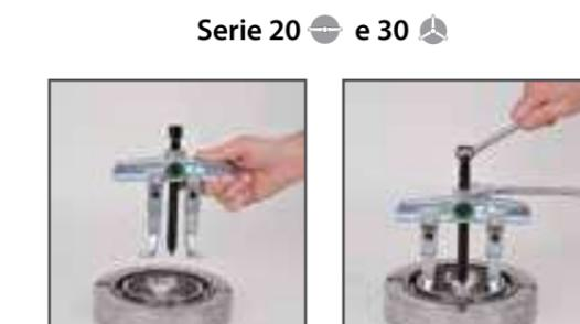
Gli estrattori possono essere utilizzati per estrazione interna ruotando le griffe. **Si tenga conto che, quando si usa l'estrattore come estrattore interno, deve essere sempre presente un punto fisso centrale per supportare la vite di pressione.**
