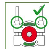
I dadi di regolazione sul separatore devono essere stretti alternativamente in modo uniforme. Ciò evita che le lame di separazione si incastrino sulla vite di pressione o che la filettatura della vite si danneggi.
